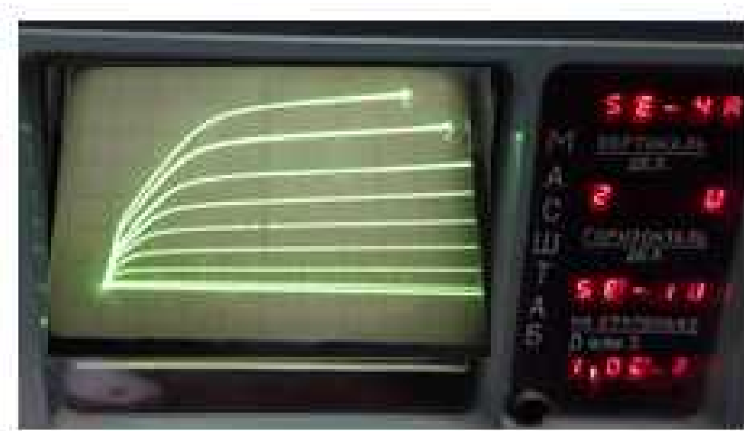
ნახ. 4.24 ერთარხიანი ველის ტრანზისტორის ვოლტ-ამპერული მახასიათებელი
